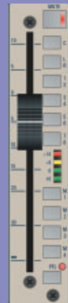
Abb. 2 - Fadersektion eines GB8 Kanalzugs
